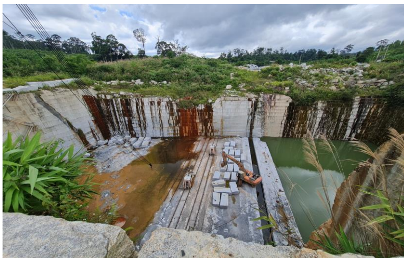
Hình 2: Máy cưa đá khối và máy xúc tại mỏ khai thác đá khối
